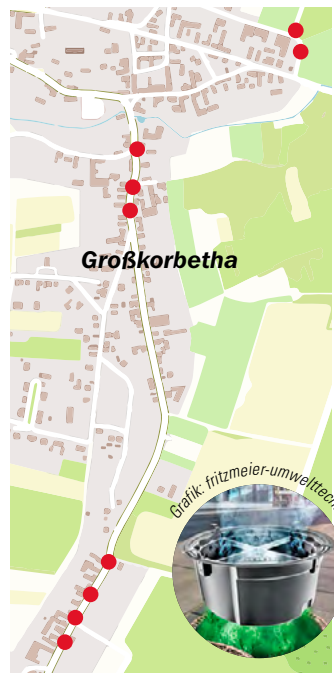
Kampf den Gerüchen: Unter anderem in Großkorbetha wurden an mehreren Stellen (rote Punkte) Biofilter (kl. Foto) im Kanal verbaut. Grafik: SPREE-PR
