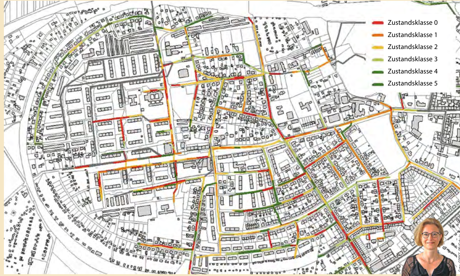
Die Karte zeigt, wo die Kanäle im AöR-Gebiet noch gut in Schuss sind (grün markiert) und wo Handlungsbedarf besteht (rot). Bildquelle: AöR
